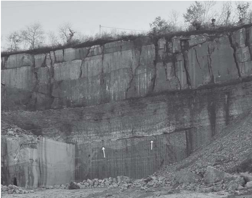
Fig. 6 - Valpolicella, fronte di cava del gruppo di Nembro (le frecce indicano il passaggio cromatico trasversale alla giacitura degli strati).
